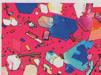
Základem tzv. „magického papíru“ technologie ZINK jsou velmi malé amorfochromické krystaly (snímky výrobce)
